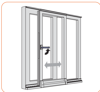
2. Klika ve vodorovné poloze: posuvná poloha dveřního křídla.
