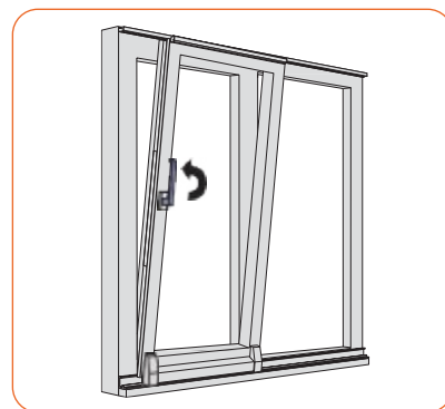
3. Horní poloha: pohodlné sklápění dveřního křídla.
